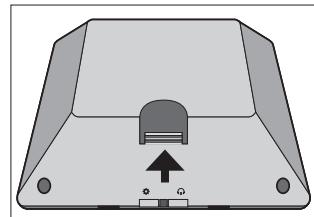
Paina lujaa kiinnityshakasta ja nostaa takasuojuksen irti.
