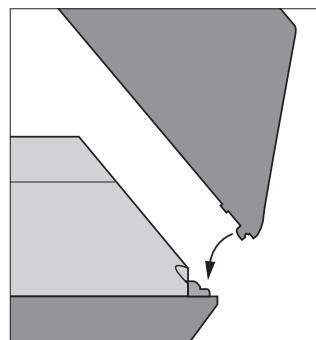
*Stellen Sie sicher, dass die Gelenkpunkte richtig eingesetzt sind, bevor Sie die rückseitige Abdeckung schließen.*
