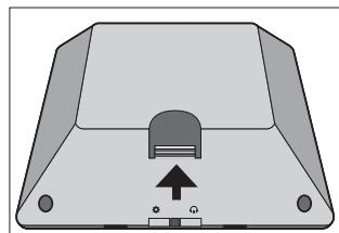
*Presione el cierre firmemente para extraer la cubierta posterior.*
