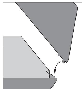
Veillez à ce que les points de pivotement soient alignés avec les bords avant de fermer le cache.
